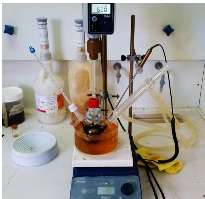
Εικόνα 2.1: Φωτογραφική απεικόνιση της διάταξης για τη σύνθεση των ΜΝΣ αποτελούμενη από μηχανικό αναδευτήρα, θερμόμετρο, ψυκτήρα και ελαιόλουτρο σε θερμαντική πλάκα.
