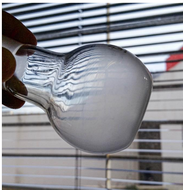
Εικόνα 2.2: Σχηματισμός λεπτού λιπιδικού υμενίου στα τοιχώματα της σφαιρικής φιάλης.
