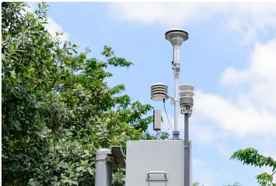
Εικόνα 7 Αισθητήρες μέτρησης ατμοσφαιρικών ρύπων σε σταθμό παρακολούθησης της ποιότητας του αέρα (Pixel_B/Adobe Stock, 2024).
