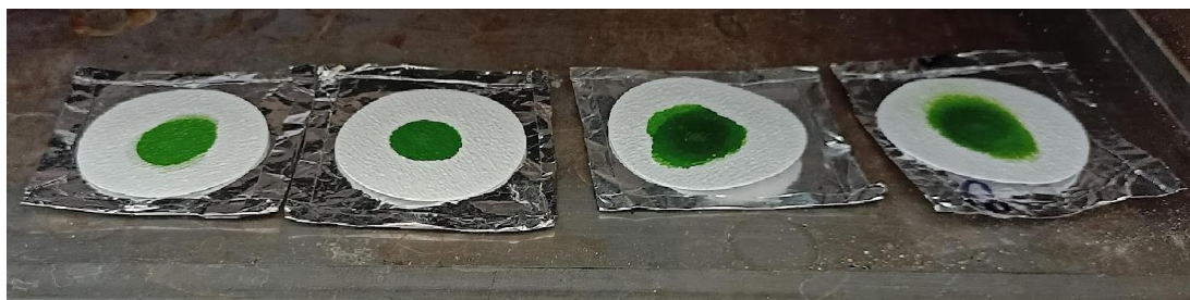
Εικόνα 10.7: Φίλτρα GF/F στους 105^{\circ}C με βιομάζα από τις προκαλλιέργειες των Chlorella minutissima και Chlorococcum oleofaciens .
