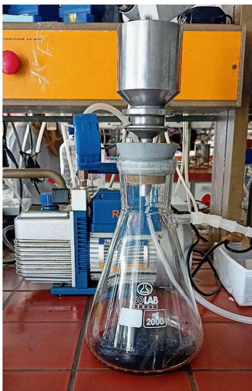
Εικόνα 10.11: Διήθηση υπό κενό της απορροής αναερόβιας χώνευσης αγροκτηνοτροφικών αποβλήτων με φίλτρο υάλου GF/F με μέση διάμετρο πόρων 0.7 \mu\text{m} .
