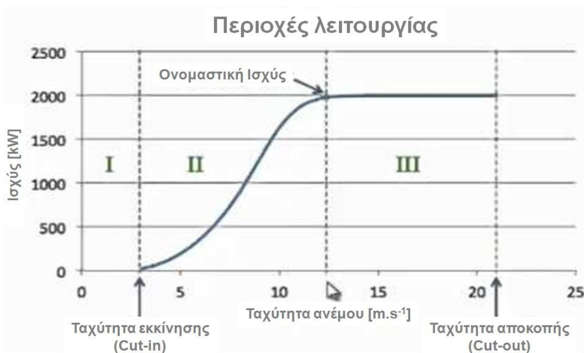
Σχήμα 1.2. Παράδειγμα καμπύλης ισχύος μιας ανεμογεννήτριας ονομαστικής ισχύος 2000 kW ( https://images.app.goo.gl/D3gqcfnPJRhNqty16 )
