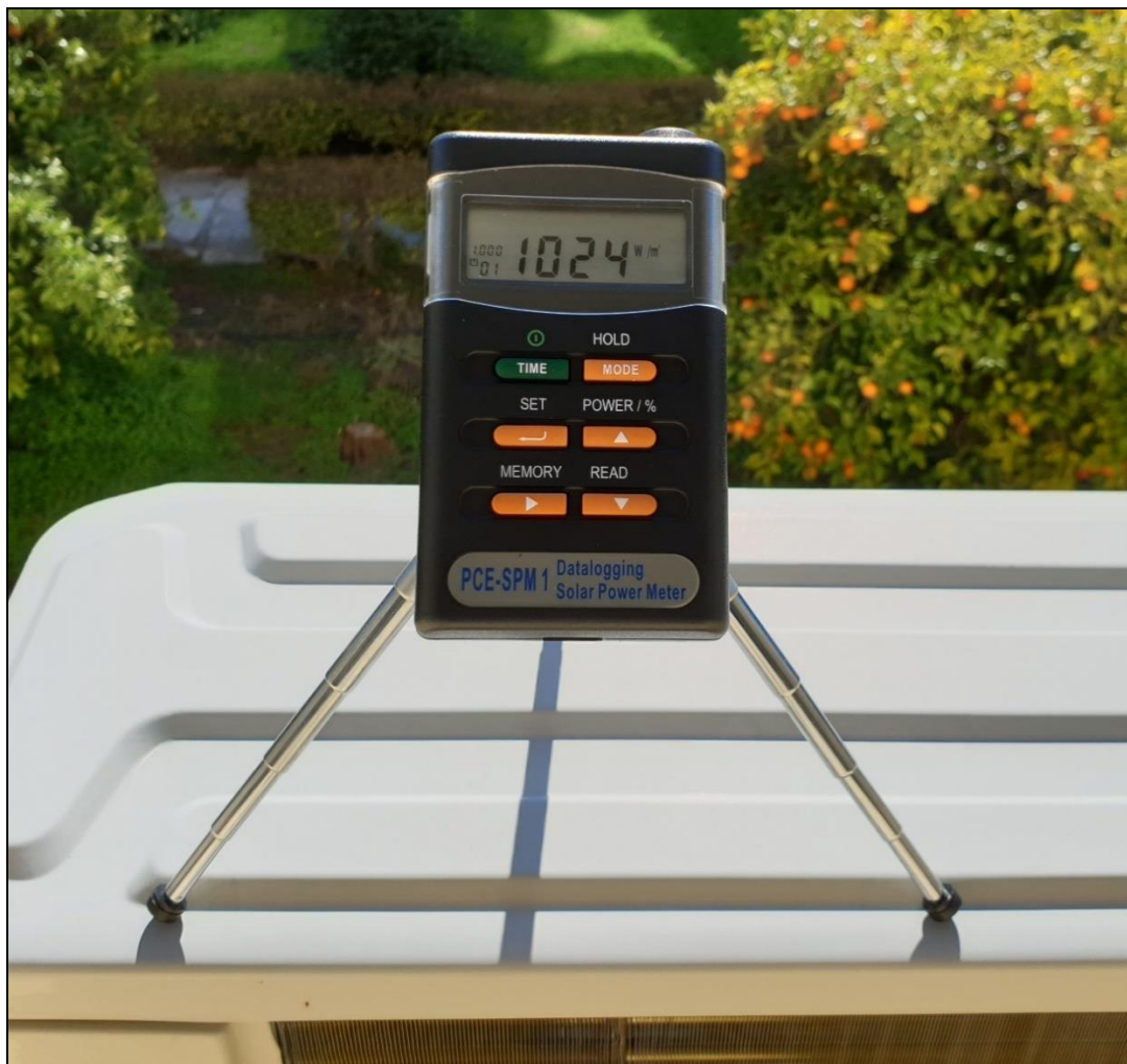
Σχήμα 2.5: Αισθητήρας Μέτρησης της Έντασης της Ηλιακής Ακτινοβολίας (PCE-SPM 1). Η μέτρηση έγινε έξω από το εργαστήριο στο οποίο έγιναν οι κολλήσεις των ωμικών συνδέσεων, 1024 \text{ W/m}^2 .
