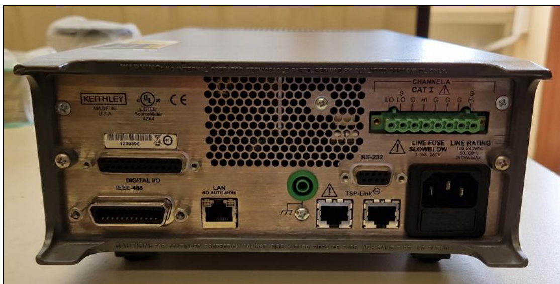
Σχήμα 2.4: Η πίσω όψη του Source Measure Unit (SMU 2611A) της Keithley
