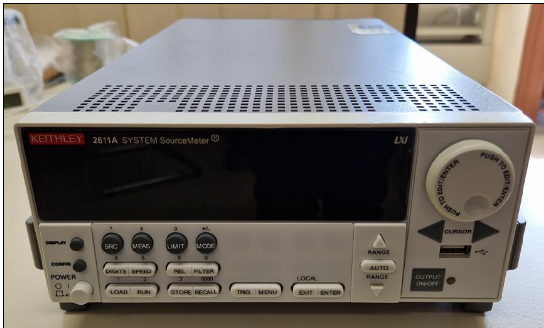
Σχήμα 2.3: Source Measure Unit of Keithley (SMU 2611A) (Μπροστινή όψη)
