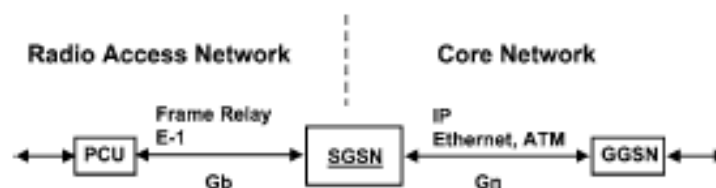
Σχ. 3.29 Διεπαφές ανάμεσα στις μονάδες του δικτύου GPRS.
