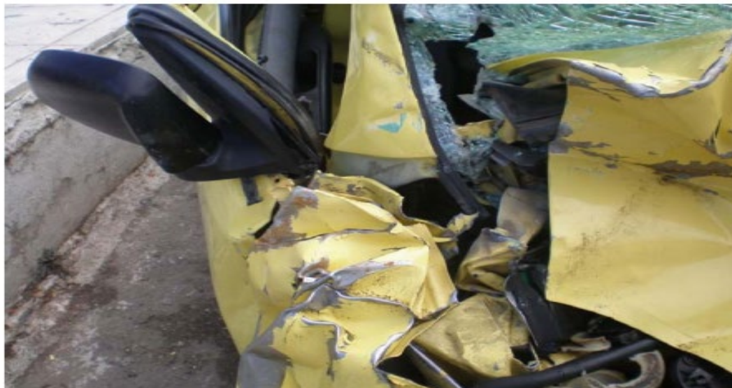
Σχήμα 62 Hyundai Atos AXP-9407 η εμπρόσθια δεξιά πλευρά. Προοδευτική υποχώρηση κατά την εξέλιξη της σύγκρουσης.
