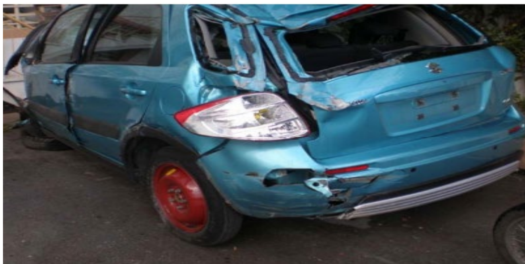
Σχήμα 44 Suzuki SX4 αριστερή και οπίσθια πλευρά, πρώτη επαφή με το μεταλλικό προστατευτικό στηθαίο στο ύψος του οπίσθιου προφυλακτήρα πριν την ανατροπή.
