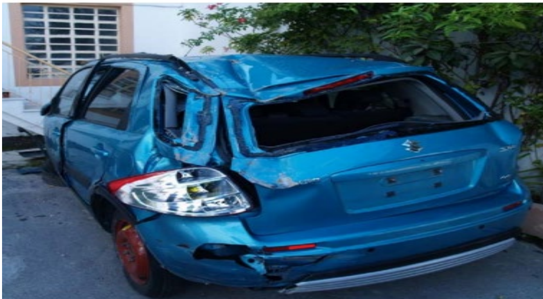
Σχήμα 45 Suzuki SX4 αριστερή και οπίσθια πλευρά, σύγκρουση με το μεταλλικό προστατευτικό στηθαίο στην οροφή και την οπίσθια αριστερή γωνία του αμαξώματος μετά την ανατροπή.
