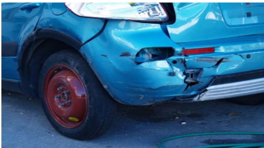
Σχήμα 48 Suzuki SX4 οπίσθιος προφυλακτήρας αριστερά. Πρώτη επαφή με το μεταλλικό στηθαίο.
