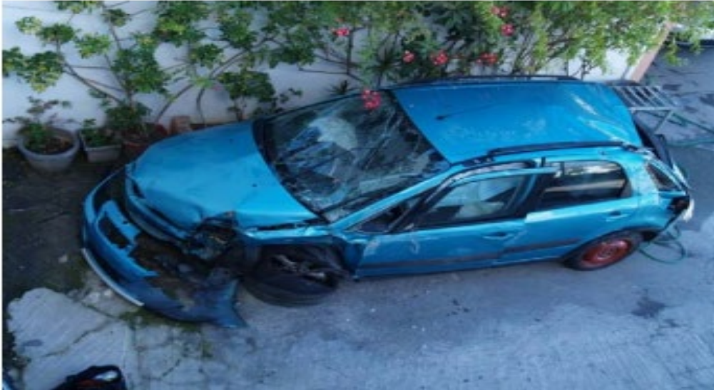
Σχήμα 39 Suzuki SX4 η εμπρόσθια και αριστερή πλευρά και η επιφάνεια σύγκρουσης με το Hyundai Atos.
