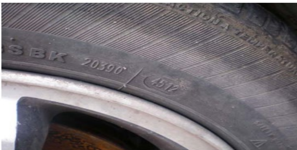
Σχήμα 67 . Hyundai Atos AXP-9407 ελαστικό εμπρός αριστερά εβδομάδα παραγωγής 45/2012.
