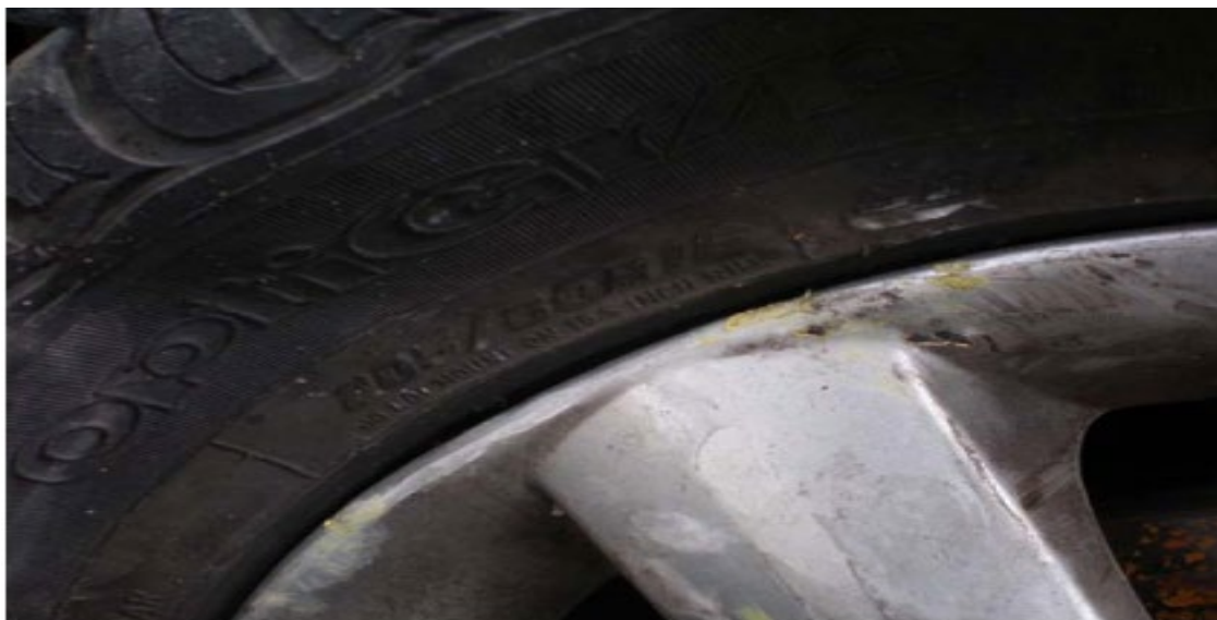
Σχήμα 43 Suzuki SX4 εμπρός αριστερός τροχός και κίτρινο χρώμα από τη σύγκρουση με το Hyundai Atos.
