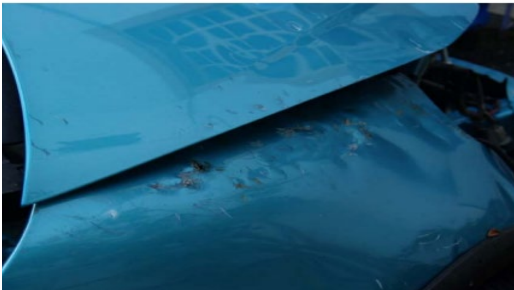
Σχήμα 54 . Suzuki SX4 κάλυμα κινητήρα και εμπρόσθιου τροχού στη δεξιά πλευρά. Ίχνη επαφής με το οδόστρωμα κατά την ανατροπή.
