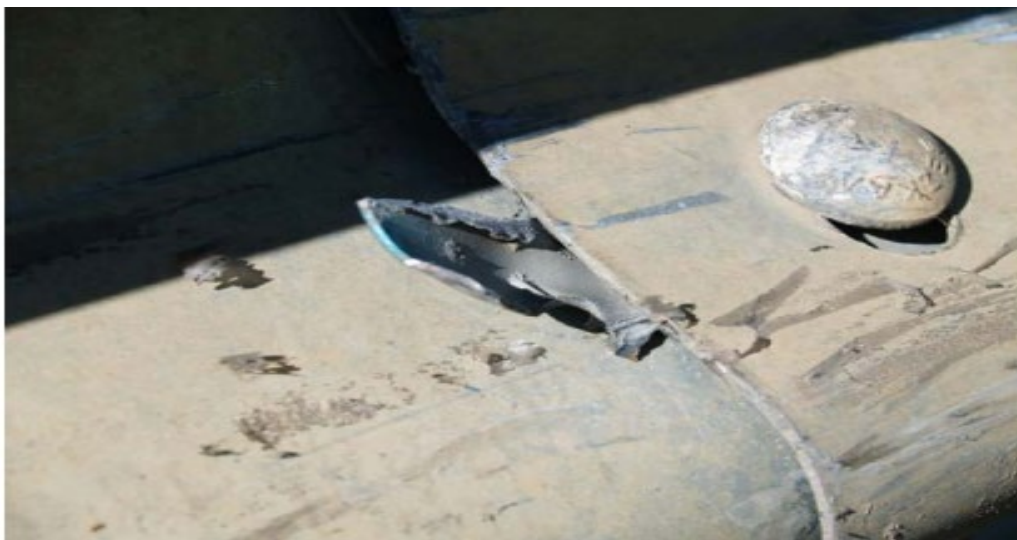
Σχήμα 82 Αγκίστρωση του οπίσθιου σοληνωτού προφυλακτήρα στο μεταλλικό σθηθαίο.
