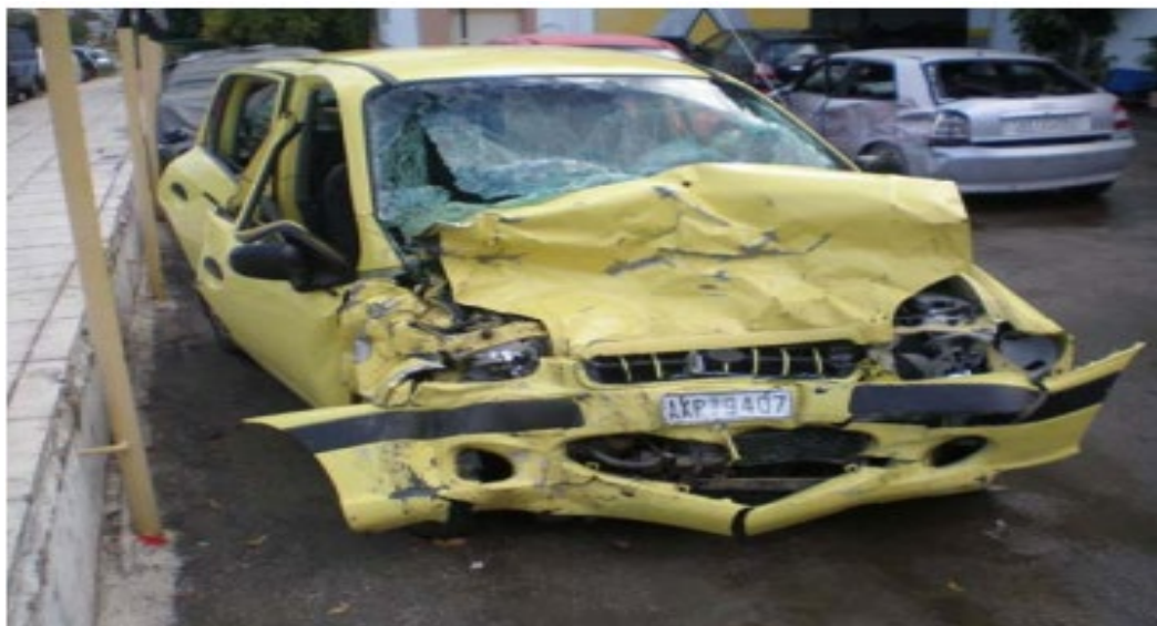
Σχήμα 60 Hyundai Atos AXP-9407 η εμπρόσθια και δεξιά πλευρά. Σύγκρουση υπό γωνία 45ο ως προς το διαμήκη άξονα του Hyundai Atos.
