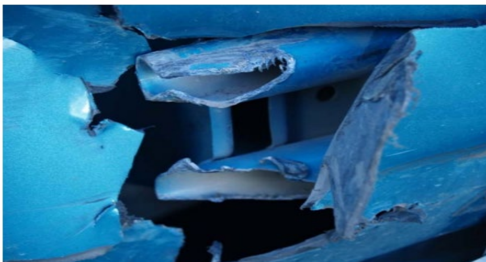
Σχήμα 83 Suzuki SX4, αγκίστρωση του οπίσθιου σοληνωτού προφυλακτήρα στο μεταλλικό σθηθαίο και έναρξη ανατροπής.
