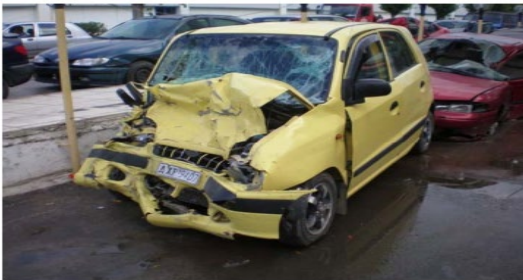
Σχήμα 59 Hyundai Atos AXP-9407 η εμπρόσθια και αριστερή πλευρά. Σύγκρουση υπό γωνία 45ο ως προς το διαμήκη άξονα του Hyundai Atos.
