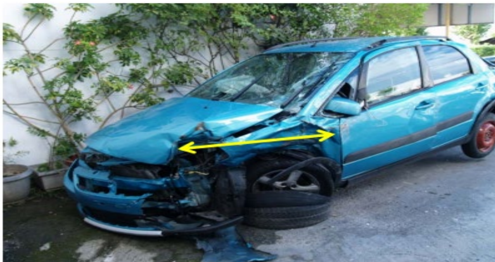
Σχήμα 40 Suzuki SX4 η εμπρόσθια και αριστερή πλευρά και πλάτος επιφάνειας σύγκρουσης με το Hyundai Atos 1000 χιλ.
