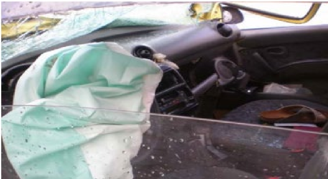
Σχήμα 69 Hyundai Atos AXP-9407 θέση οδηγού, ενεργοποίηση αερόσακου και εφαρμογή της ζώνης ασφαλείας πριν τη σύγκρουση.
