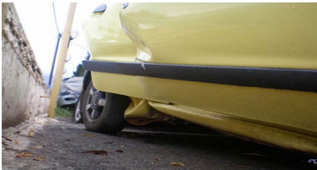
Σχήμα 65 Hyundai Atos AXP-9407 η οπίσθια δεξιά πλευρά. Παραμόρφωση της διαμήκουσ δοκού κάτω από την οπίσθια δεξιά θύρα.
