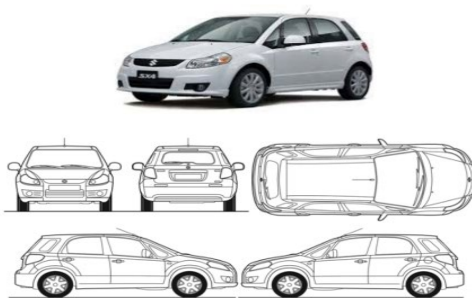
Σχήμα 37 Suzuki SX4 1.6 5-door 2006-2012, Γενικές διαστάσεις - 4140x1755x1650 χιλ., μεταξόνιο 2500 χιλ. [14]
