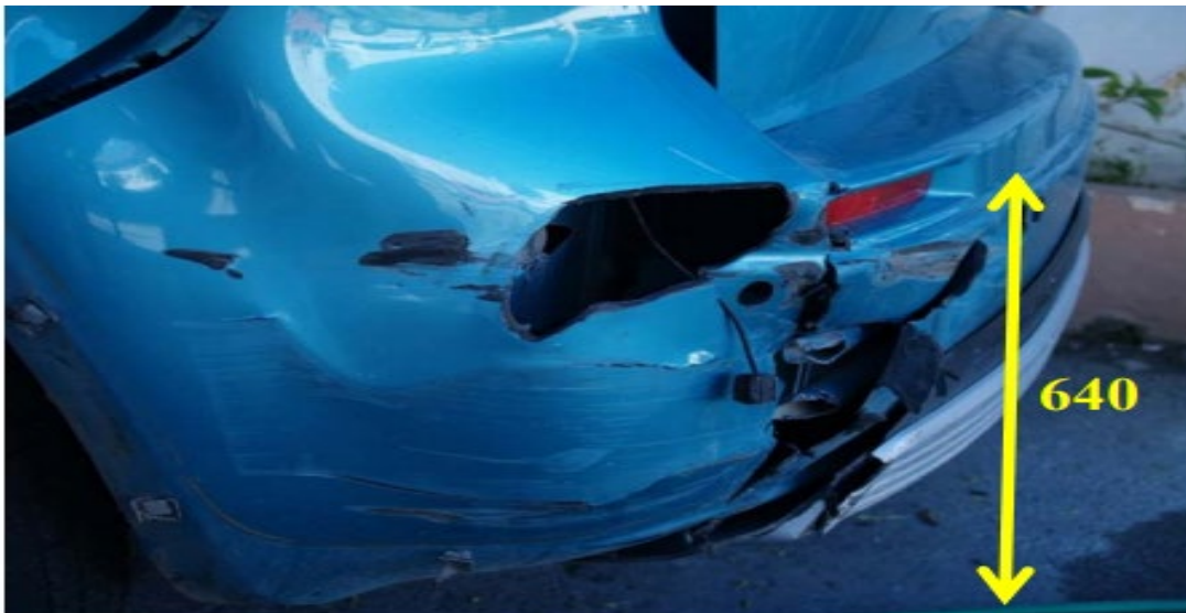
Σχήμα 78 Suzuki SX4, επαφή του οπίσθιου προφυλακτήρα με το μεταλλικό στηθαίο, ύψος στο σημείο επαφής 640 χιλ.
