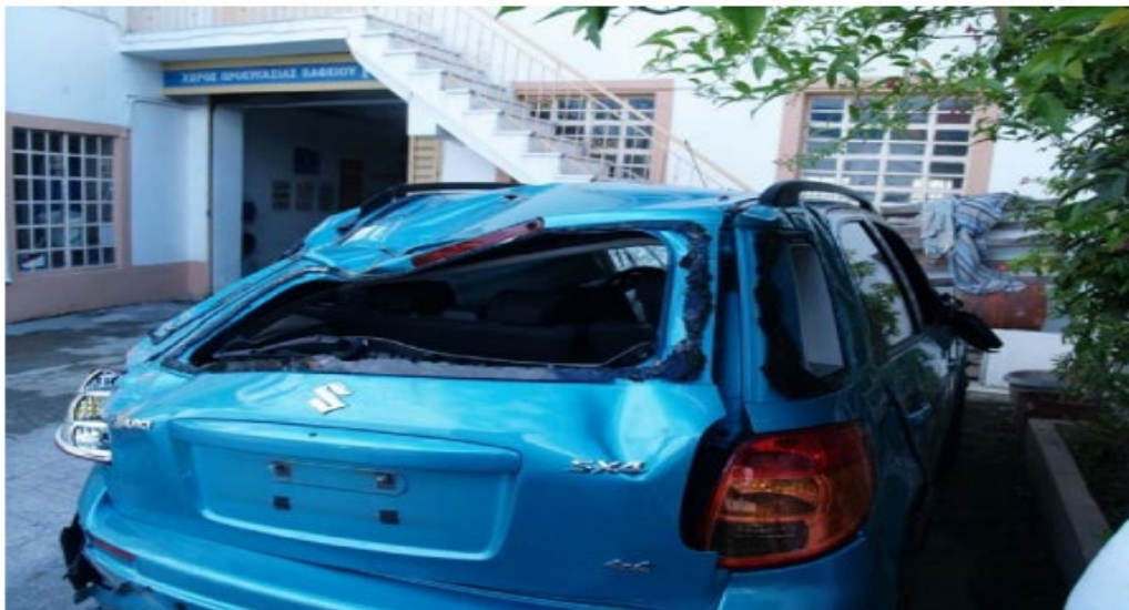
Σχήμα 49 Suzuki SX4 η οπίσθια και δεξιά πλευρά και η επιφάνεια σύγκρουσης με το μεταλλικό στηθαίο άνω αριστερά μετά την ανατροπή.
