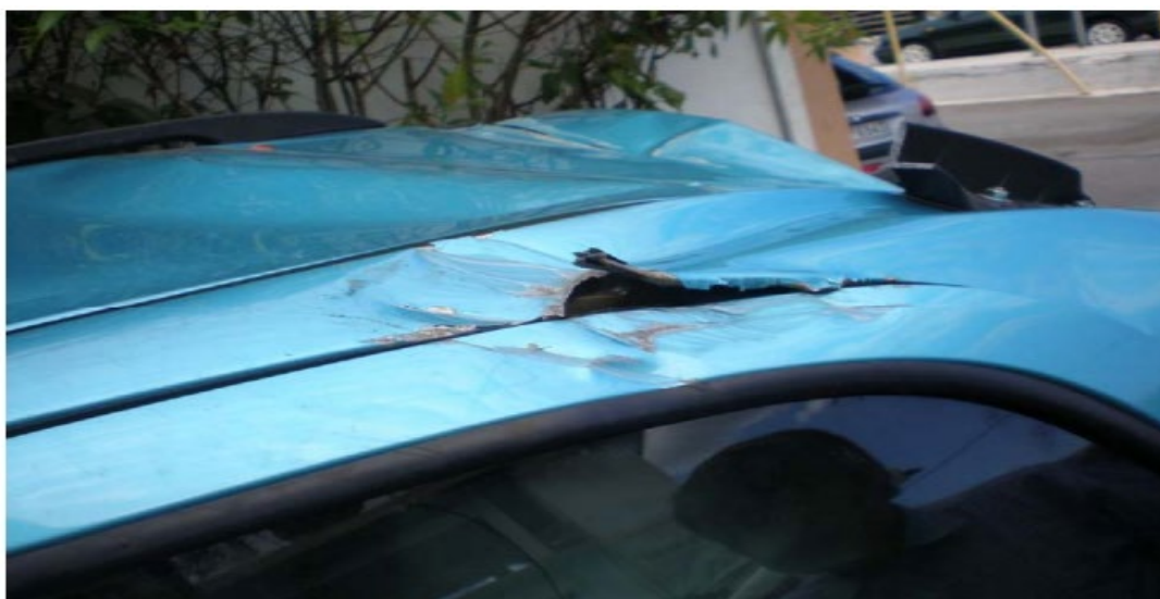
Σχήμα 87 Suzuki SX4, σύγκρουση της οροφής στο μεταλλικό ορθοστάτη (Σχ. 81), η οροφή στο έδαφος και οι τροχοί στον αέρα.
