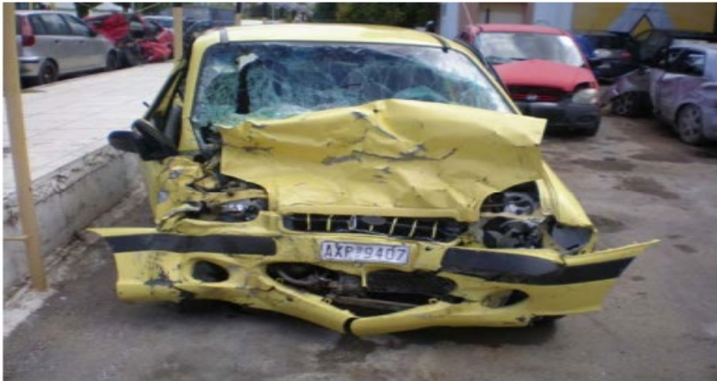
Σχήμα 61 Hyundai Atos AXP-9407 η εμπρόσθια και αριστερή πλευρά. Σύγκρουση υπό γωνία 45ο ως προς το διαμήκη άξονα του Hyundai Atos.
