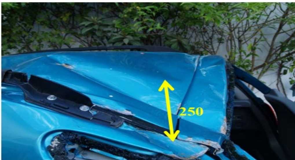
Σχήμα 85 Suzuki SX4, σύγκρουση της οροφής στο μεταλλικό στηθαίο και υποχώρηση 250 χιλ.
