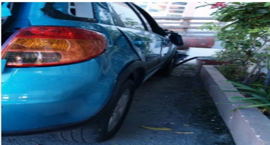
Σχήμα 50 Suzuki SX4 η οπίσθια δεξιά πλευρά και παραμορφώσεις από την επαφή με το οδόστρωμα κατά την ανατροπή.
