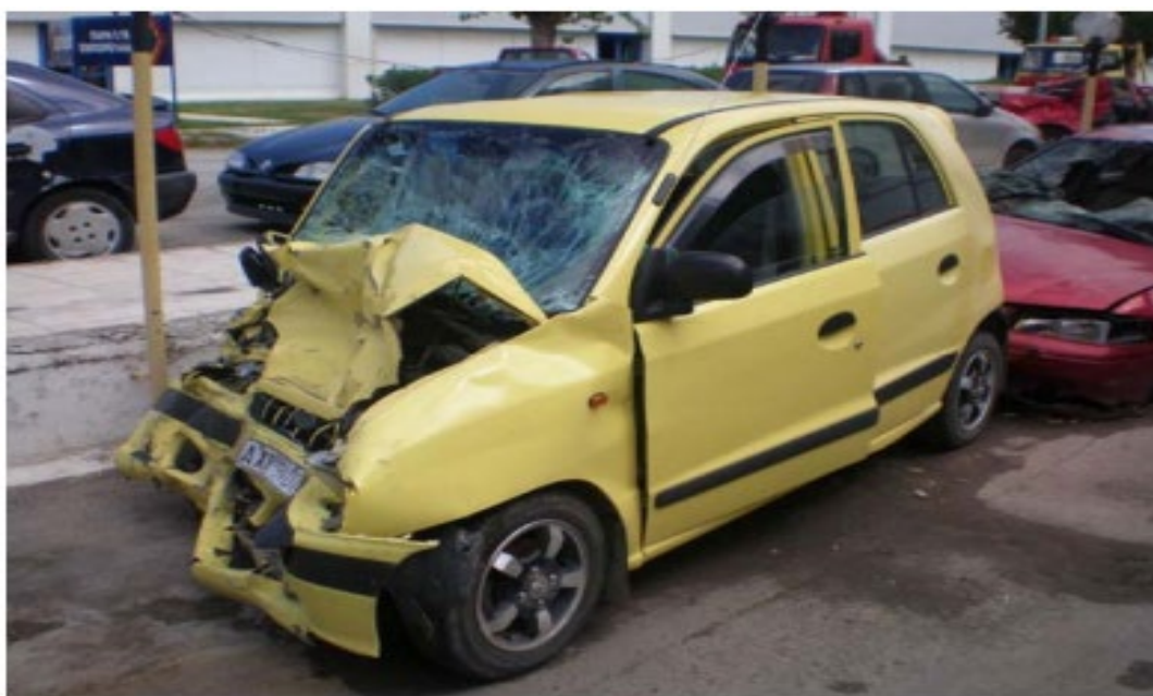
Σχήμα 58 Hyundai Atos η εμπρόσθια και αριστερή πλευρά. Σύγκρουση υπό γωνία 45ο ως προς το διαμήκη άξονα του Hyundai Atos.
