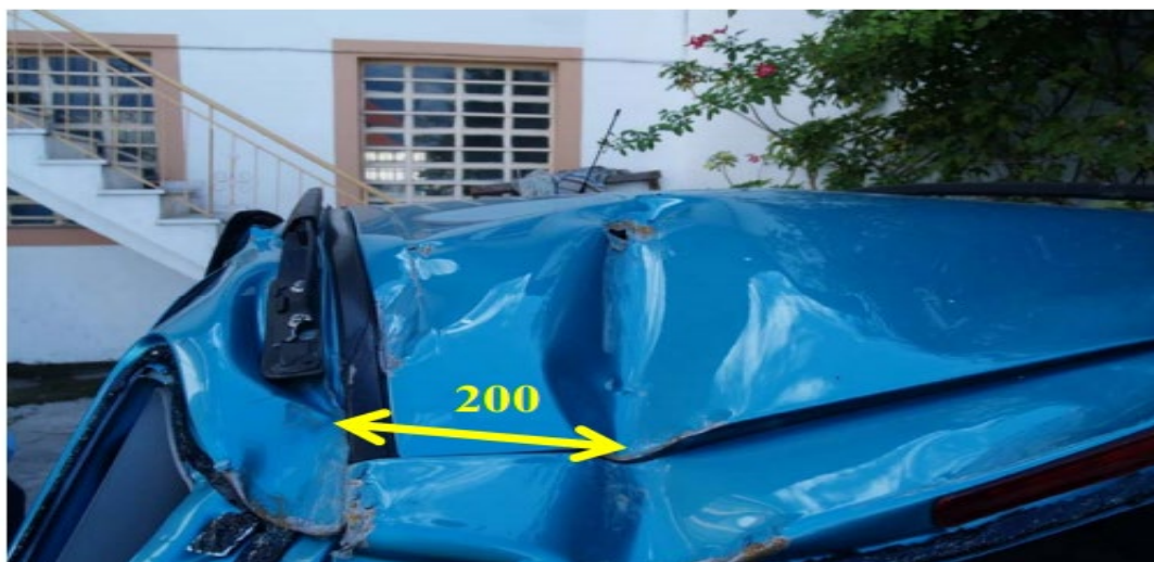
Σχήμα 86 Suzuki SX4, σύγκρουση της οροφής στο μεταλλικό στηθαίο, πλάτος ιχνών ιχνών μεταλλικού στηθαίου 200 χιλ.
