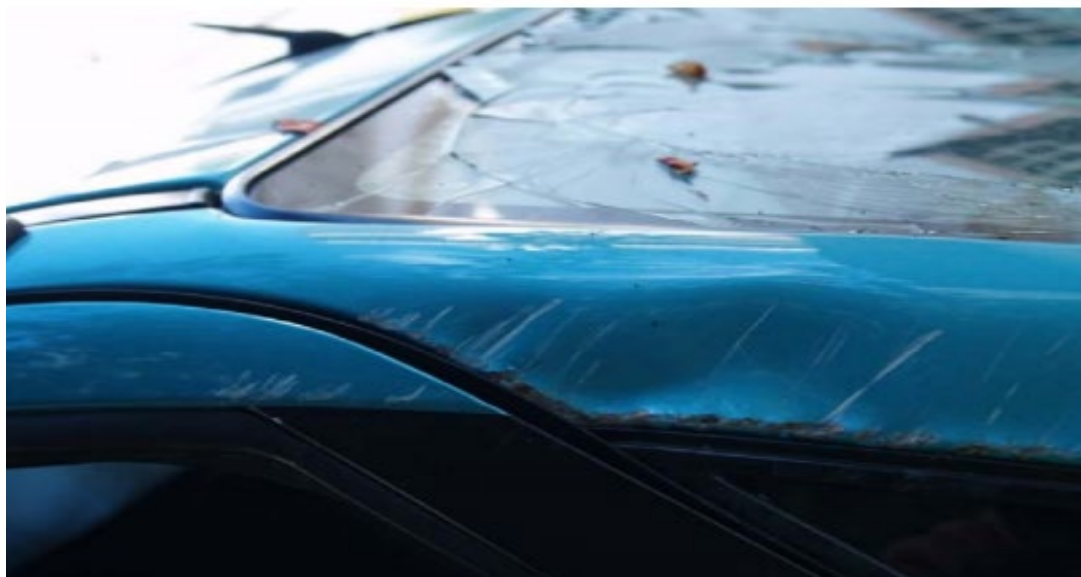
Σχήμα 53 Suzuki SX4 η δεξιά δοκός-A ο εμπρόσθιος ανεμοθώραξ και ίχνη επαφής με το οδόστρωμα κατά την ανατροπή. Ανατροπή περί το διαμήκη άξονα του αμαξώματος.
