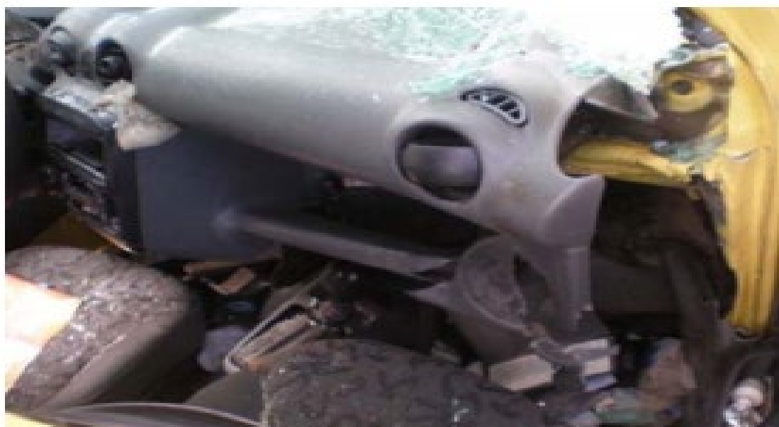
Σχήμα 70 Hyundai Atos AXP-9407 θέση συνοδηγού, περιορισμός του διαθέσιμου χώρου λόγω της σύγκρουσης.
