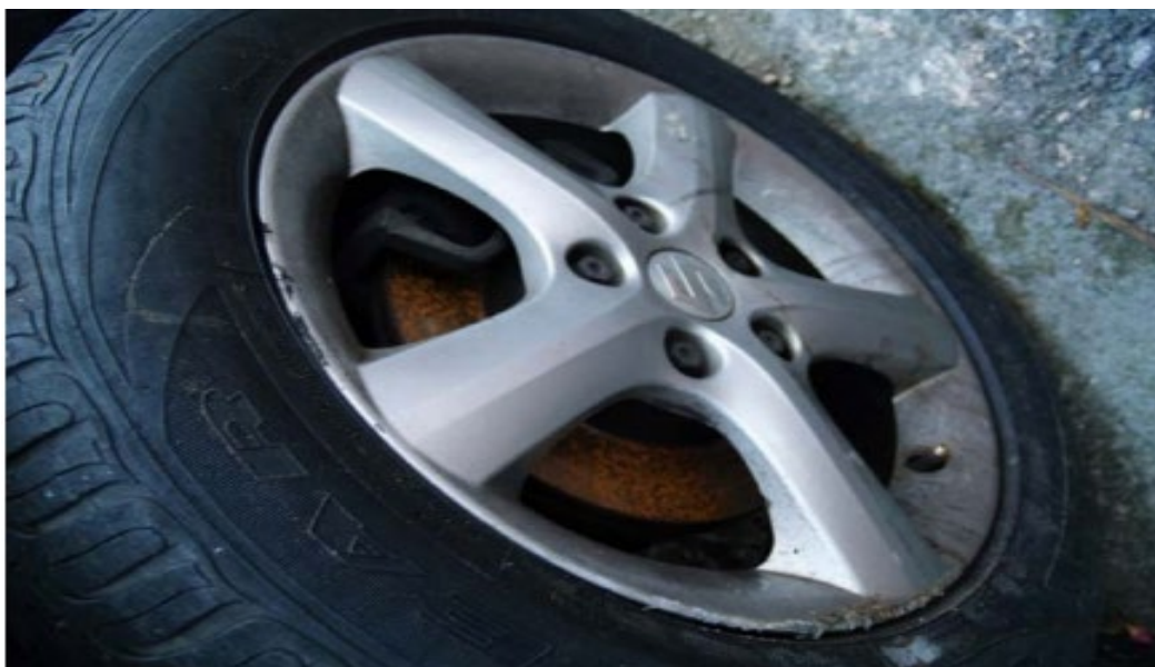
Σχήμα 55 . Suzuki SX4 εμπρόσθιος δεξιός τροχός και ίχνη επαφής με το οδόστρωμα κατά την ανατροπή.
