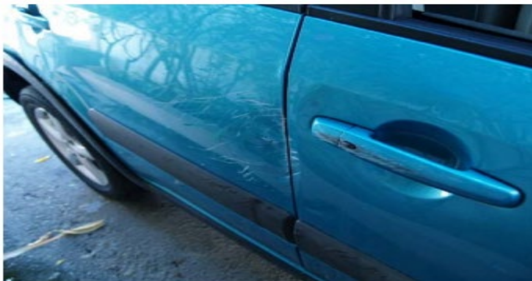
Σχήμα 52 Suzuki SX4 η δεξιά πλευρά και ίχνη επαφής με το οδόστρωμα κατά την ανατροπή.
