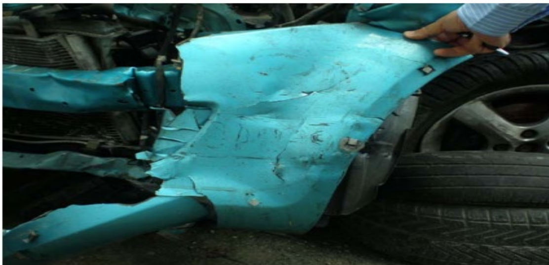
Σχήμα 42 Suzuki SX4 η εμπρόσθια αριστερή πλευρά του προφυλακτήρα και αποτύπωμα της πινακίδας του Hyundai Atos P-940 (ανάστροφα) από τα ψηφία AXP9407.
