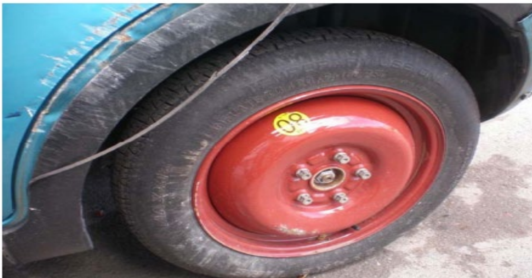
Σχήμα 47 Suzuki SX4 αριστερός οπίσθιος εφεδρικός τροχός. Μέγιστη επιτρεπόμενη ταχύτης 80 χλ.μ./ώρα.
