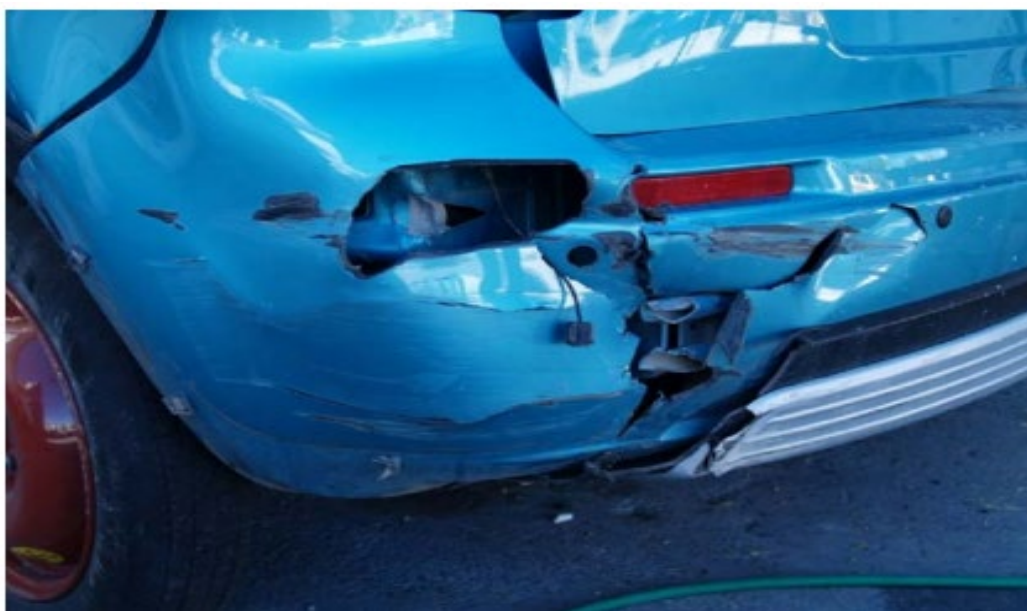
Σχήμα 81 Suzuki SX4, αγκίστρωση του οπίσθιου προφυλακτήρα στο μεταλλικό στηθαίο.
