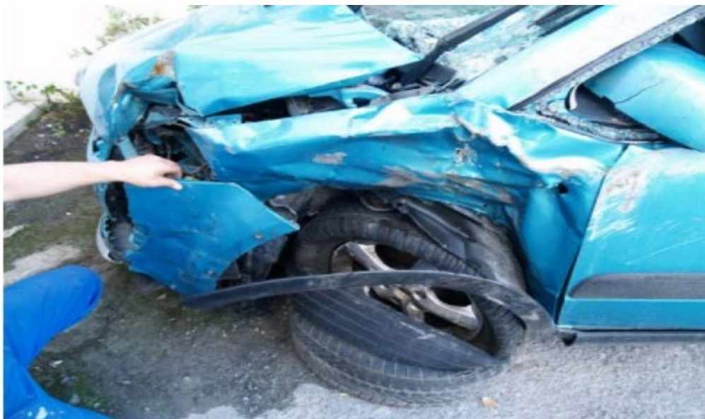
Σχήμα 41 Suzuki SX4 η εμπρόσθια αριστερή πλευρά του προφυλακτήρα και αποτύπωμα της πινακίδας του Hyundai Atos P-940 (ανάστροφα) από τα ψηφία AXP9407. Σύγκρουση υπό γωνία 45ο ως προς το διαμήκη άξονά του.
