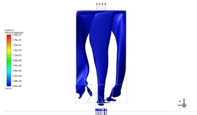
Σχήμα 5.17. Κάτοψη ισο-επιφανειακής ταχύτητας 0.5 \text{ m/s} για παροχή Q=600 \text{ m}^3/\text{s} στο στόμιο STS 1R20 με το damper στη μεσαία θέση.
