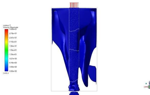
Σχήμα 5.63. Κάτοψη ισο-επιφανειακής ταχύτητας 0.5 \text{ m/s} για παροχή Q=1300 \text{ m}^3/\text{s} στο στόμιο STS 2R20 με το damper στη μεσαία θέση.
