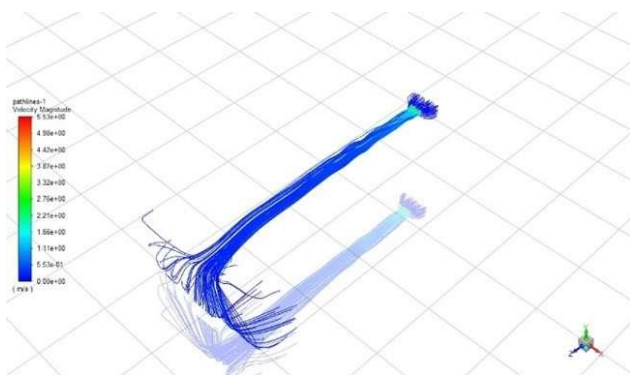
Σχήμα 5.56. Ροϊκές γραμμές για παροχή Q=600 m^3/s στο στόμιο STS 2R20 με το damper στη μεσαία θέση.
