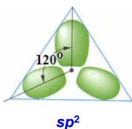
Σχήμα 9: Γεωμετρική διάταξη sp^2 υβριδισμού.
