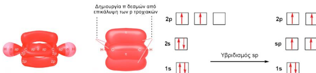
Σχήμα 16: Δημιουργία \sigma και \pi δεσμών στο μόριο του ακετυλενίου ( C_2H_2 ) και υβριδισμός sp .
