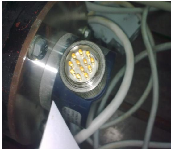
Σχ.2.17. Ακροδέκτες εξόδου της ταχογεννήτριας
