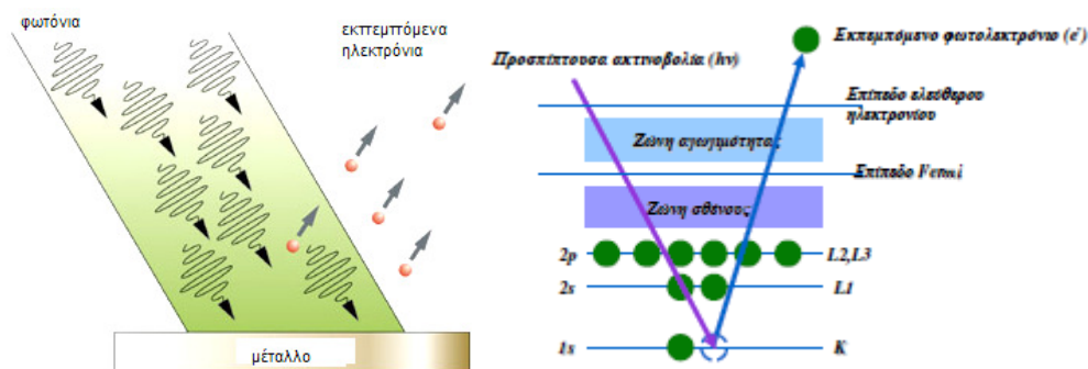
Σχήμα 2.6: Σχηματική απεικόνιση του φωτοηλεκτρικού φαινομένου (αριστερά). Δεξιά παρουσιάζεται σχηματικά η εκπομπή ενός φωτοηλεκτρονίου από εσωτερικό τροχιακό του ατόμου.
