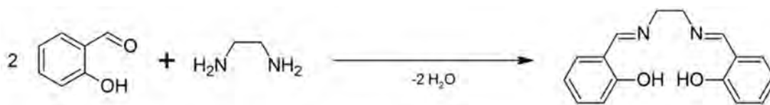
Σχήμα 51: Αντίδραση σύνθεσης της βάσης Schiff δις(σαλικυλαλδεΰδη)αιθυλενοδιαμίνη ( H_2salen ).
