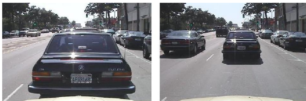
Εικόνα 16. Εξαιτίας της συνεχώς μεταβαλλόμενης απόστασης του προπορευόμενου οχήματος από το ego vehicle τα φανάρια ενός οχήματος εμφανίζονται με διαφορετική ακτίνα σε συνεχόμενα frames.
