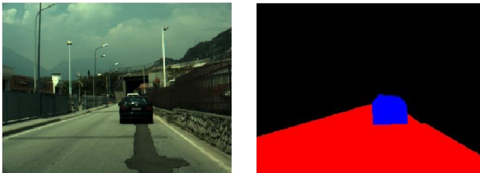
Εικόνα 53. Αριστερά το frame diplo000400-L και δεξιά η οπτική αναπαράσταση των πολυγώνων δρόμου (κόκκινο χρώμα) και εμποδίων (μπλε χρώμα).
