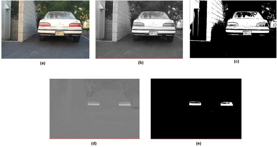
Εικόνα 10. Εφαρμογή του αλγορίθμου τμηματοποίησης του Otsu σε εικόνα της βάσης Caltech 1999. (a) αρχική εικόνα RGB, (b) grayscale, (c) Otsu στην grayscale, (d) κανάλι a^* του χώρου CIE Lab (e) Otsu στο κανάλι a^* .
