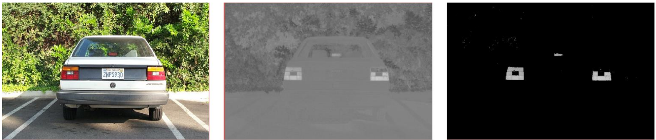
Εικόνα 18. Η αρχική εικόνα RGB (1η στήλη), το κανάλι a^* (2η στήλη) και το κόκκινο υποκανάλι a^*_r (3η στήλη).
