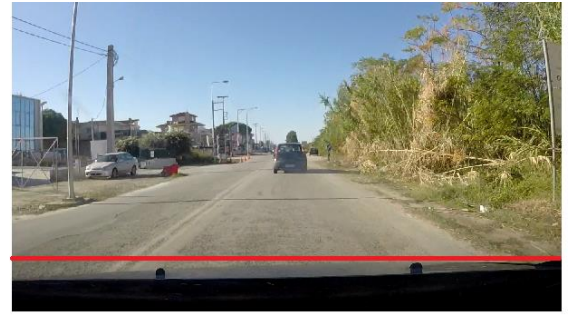
Εικόνα 46. Περιοχή του οπτικού πεδίου της κάμερας στην οποία περιεμβάλλεται το καπό του αυτοκινήτου
