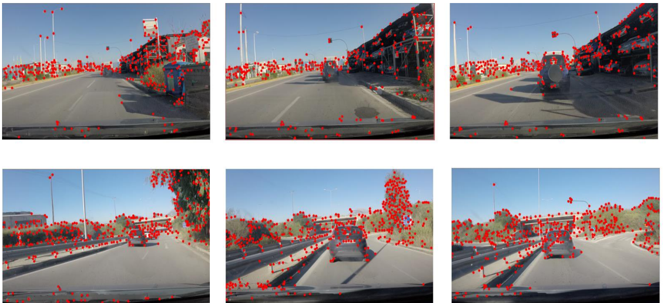
Εικόνα 41. Εφαρμογή του Lucas Kanade για την εύρεση της οπτικής ροής σε δύο βίντεο από δρόμους της Πάτρας. Σε κάθε σειρά υπάρχουν frames του ίδιου βίντεο τα οποία έχουν ληφθεί με μικρή χρονική διαφορά.
