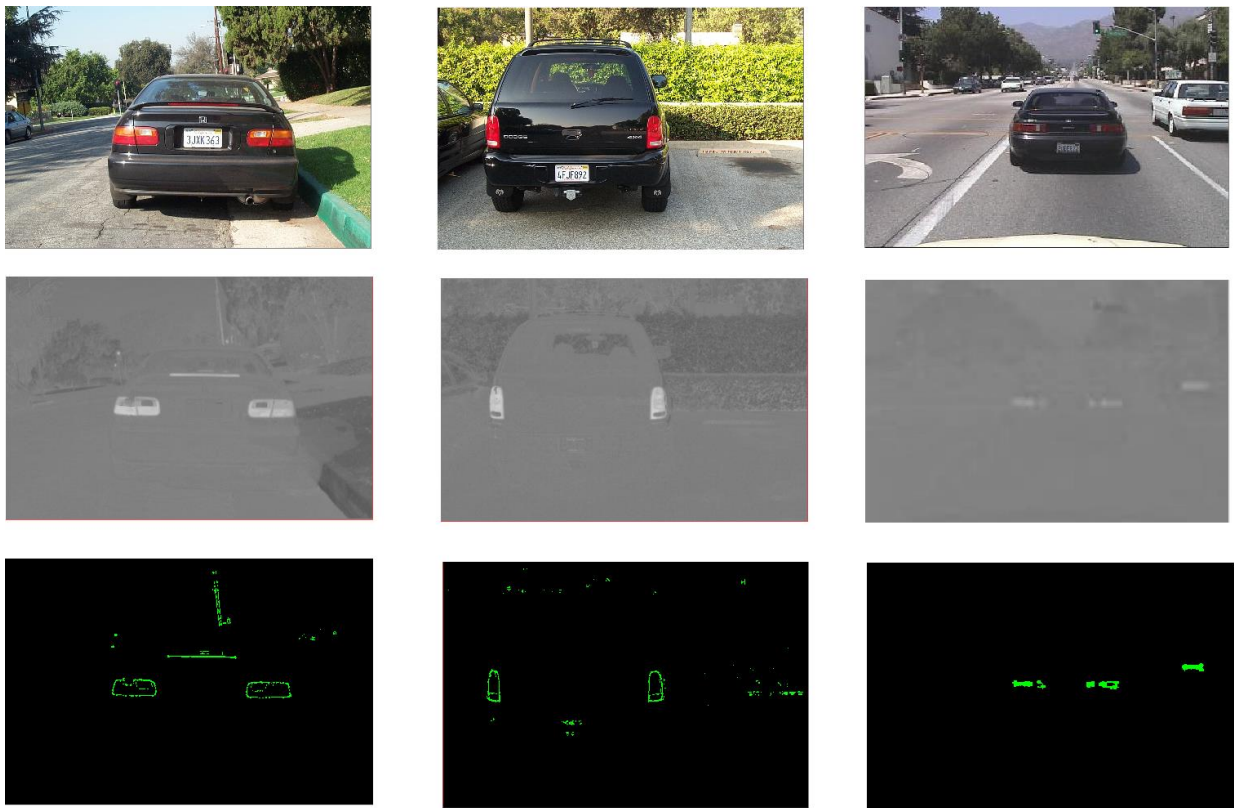
Εικόνα 9. Εφαρμογή του αλγορίθμου σε 3 εικόνες από τις βάσεις Caltech 1999, 2001. Πρώτη γραμμή η αρχική εικόνα RGB, στην δεύτερη γραμμή το κανάλι a^* και στην τρίτη γραμμή το αποτέλεσμα του FRST μαρκάροντας τα σημεία με υψηλή συμμετρία με πράσινο χρώμα.
