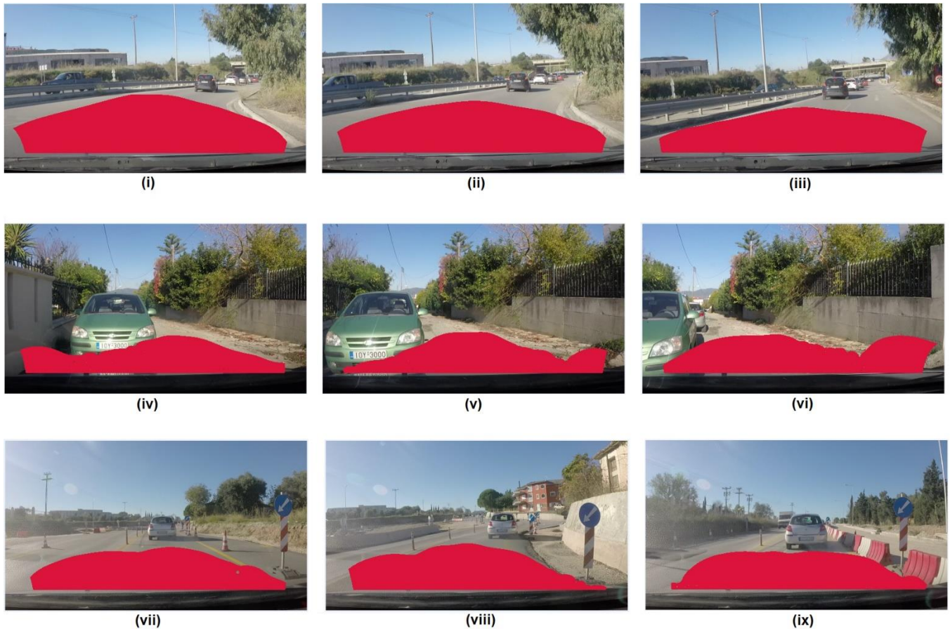
Εικόνα 52. Αποτελέσματα του συστήματος αναγνώρισης δρόμου για το dataset Patras. (i)-(iii) Δρόμος με στροφή, (iv)-(vi) εκκίνηση οχήματος από στάση με παρκαρισμένο όχημα ακριβώς μπροστά, (vii)-(ix) κυκλοφορία σε δρόμο που είναι υπό κατασκευή και οριοθετείται από κολωνάκια, πινακίδες και διαχωριστικές μπαριέρες.
