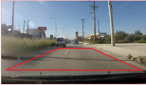
Εικόνα 44. Περιοχή ενδιαφέροντος σχήματος τραπεζίου για τοποθέτηση των seeds δρόμου.
