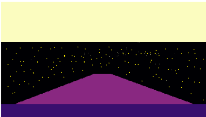
Εικόνα 49. Παράδειγμα των seeds που δίνονται στον Random Walker. Με κίτρινο χρώμα μη δρόμου, με ροζ χρώμα δρόμου, με μωβ χρώμα η ουδέτερη ζώνη και μαύρο τα unlabeled pixels.
