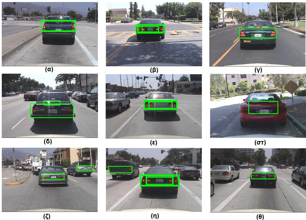
Εικόνα 31. Παραδείγματα εφαρμογής του αλγορίθμου αναγνώρισης προπορευόμενου οχήματος σε πυκνό αστικό περιβάλλον υπό διάφορες συνθήκες (Caltech 2001).
