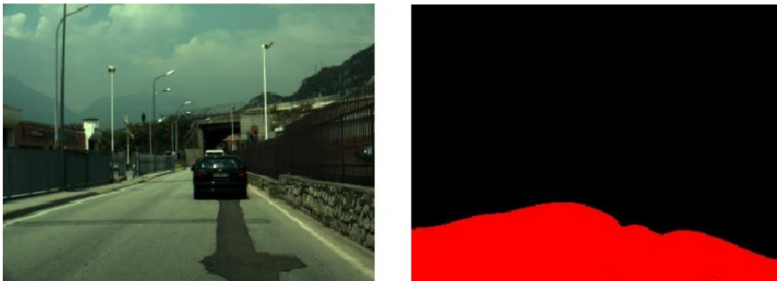
Εικόνα 54. Αριστερά το frame diplo000400-L και δεξιά το αποτέλεσμα του προτινόμενου συστήματος, όπου με κόκκινο χρώμα σημειώνεται η περιοχή δρόμου.
