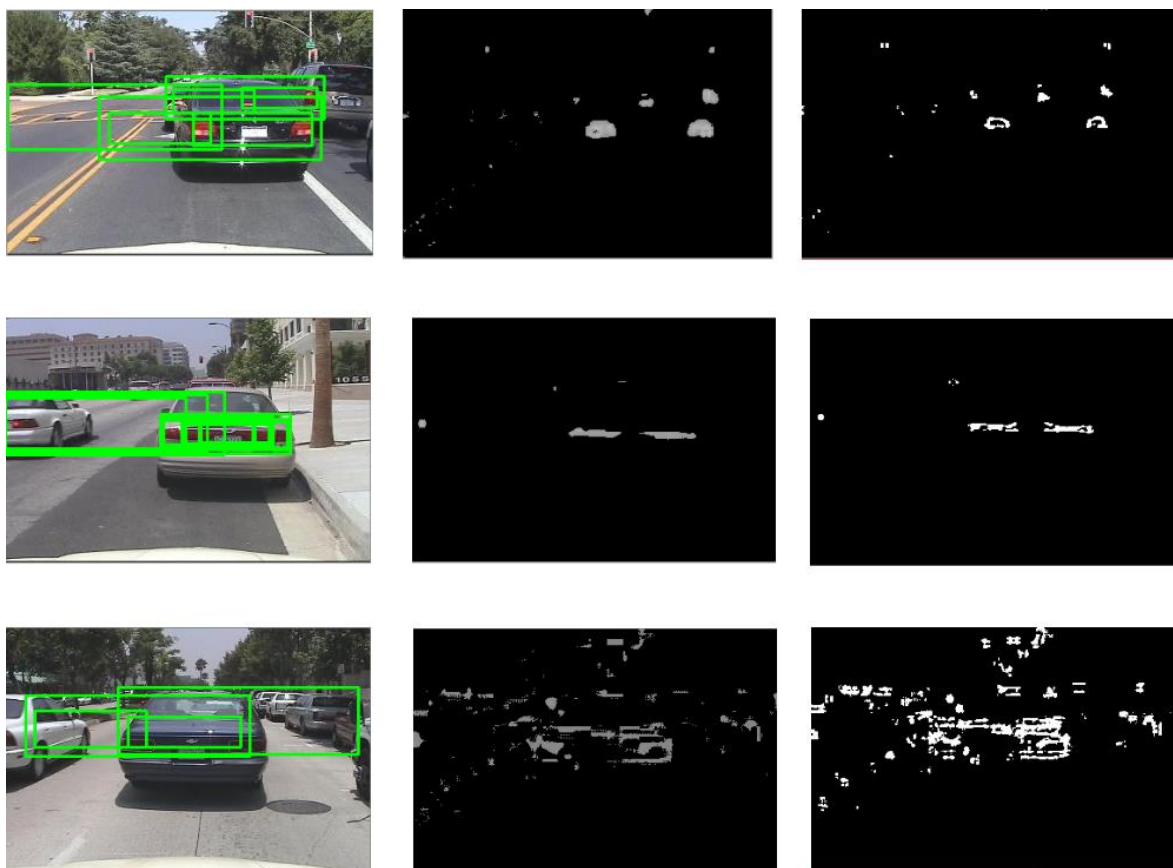
Εικόνα 27. Πρώτη στήλη η RGB εικόνα με τις περιοχές ενδιαφέροντος σχηματισμένες, δεύτερη στήλη το κόκκινο υποκανάλι a*r και τρίτη στήλη η δυαδική εικόνα κατά Otsu.
