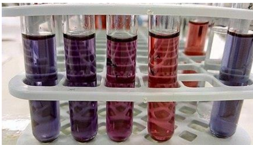
Εικόνα 2. Βιοαισθητήρας νανοσωματιδίων χρυσού (Au-NP) για γλουταθειόνη (GSH). Τα AuNPs λειτουργικοποιούνται με μια ομάδα που συνδέεται με το GSH και προκαλεί μερική υποβάθμιση του NP και επομένως αλλαγή χρώματος. Η ακριβής ποσότητα GSH μπορεί να προσδιοριστεί με φασματοσκοπία UV-ορατής χρησιμοποιώντας μια καμπύλη βαθμονόμησης.
