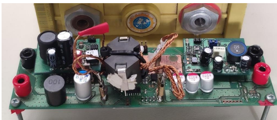
Σχήμα 3.16: Το εργαστηριακό πρωτότυπο του μετατροπέα Flyback.
