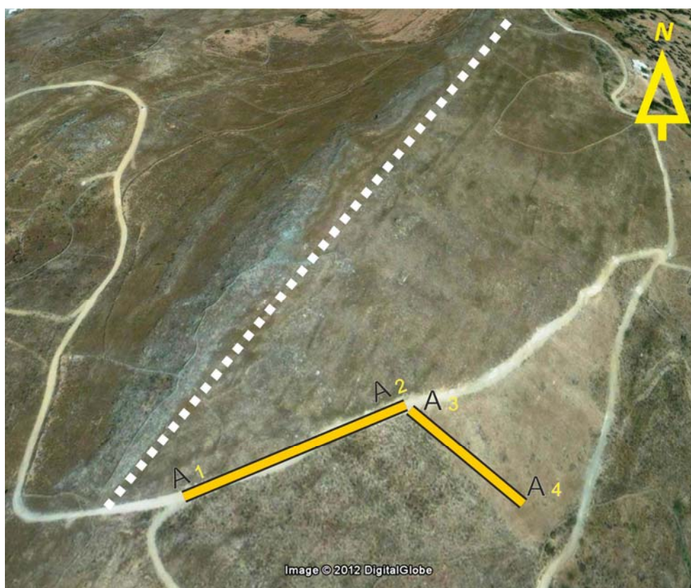
Εικόνα 4.2. Τομές δειγματοληψίας ( A_1 - A_2 και A_3 - A_4 ) στην ζώνη διάτμησης του Φελλού. Με άσπρη στικτή γραμμή απεικονίζεται η διεύθυνση της μυλωνιτικής φολίωσης στην ζώνη διάτμησης. Η θέση A_4 αντιπροσωπεύει την θέση όπου χαρτογραφήθηκε η επιφανειακή εμφάνιση επιδοτιτικών – σχιστολίθων, και από την οποία λήφθηκαν δείγματα για πετρολογική μελέτη ( Κεφάλαιο 5 ).
