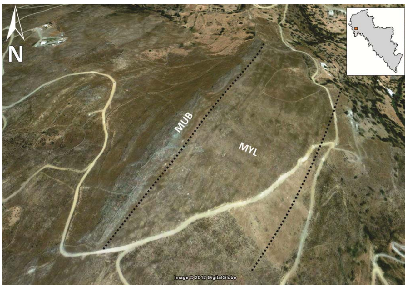
Εικόνα 3.1. Οριοθέτηση της ζώνης διάτμησης με μαύρες στικτές γραμμές. Η περιοχή μελέτης πάνω δεξιά στο νησί της Άνδρου απεικονίζεται σε τετραγωνισμένο πορτοκαλί πλαίσιο (Εικόνα από Google earth). Με MUB υποδηλώνεται η επιφανειακή εμφάνιση των μετα – υπερβασικών σωμάτων και με MYL το σώμα της μυλωνιτικής ζώνης.
