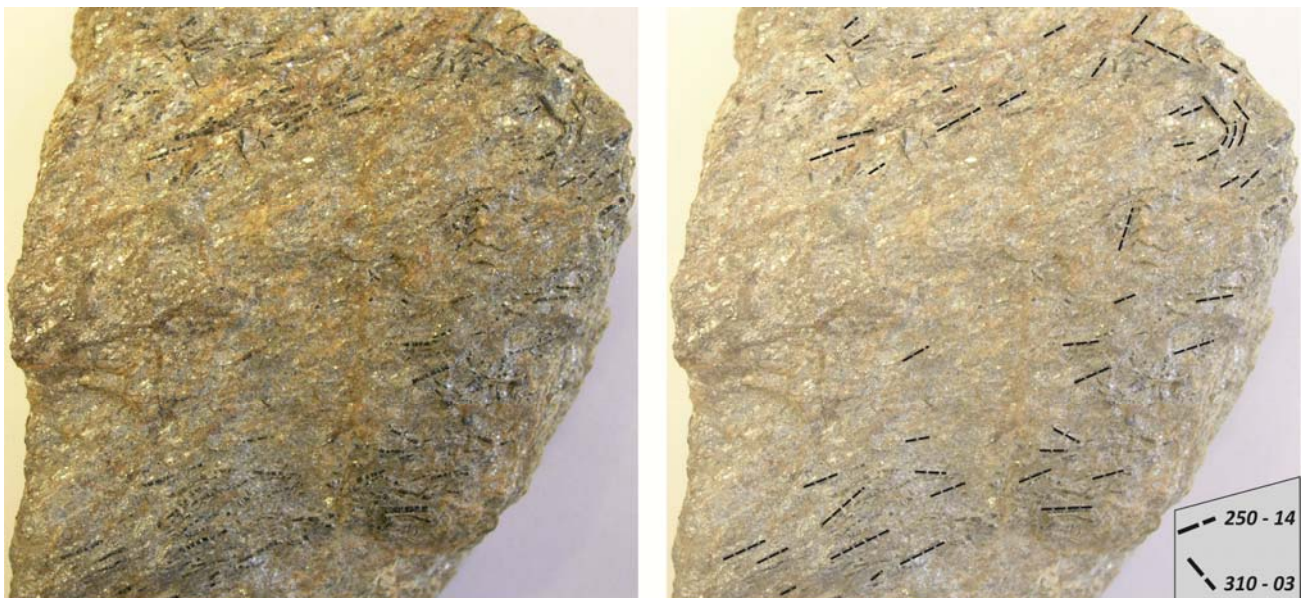
Εικόνα 3.6. Μεταβολές στον προσανατολισμό των γραμμώσεων έκτασης σε boudinaged κρυστάλλους τουρμαλίνη. Στην αριστερή φωτογραφία απεικονίζεται δείγμα χειρός από μυλωνιτιωμένη μεταπηλιτική λιθολογία. Στην δεξιά φωτογραφία έχουν ιχνογραφηθεί οι boudinaged κρύσταλλοι τουρμαλίνη και κάτω δεξιά σε γκρι πλαίσιο αναγράφονται οι διευθύνσεις βύθισης των γραμμώσεων έκτασης που παρατηρούνται.
