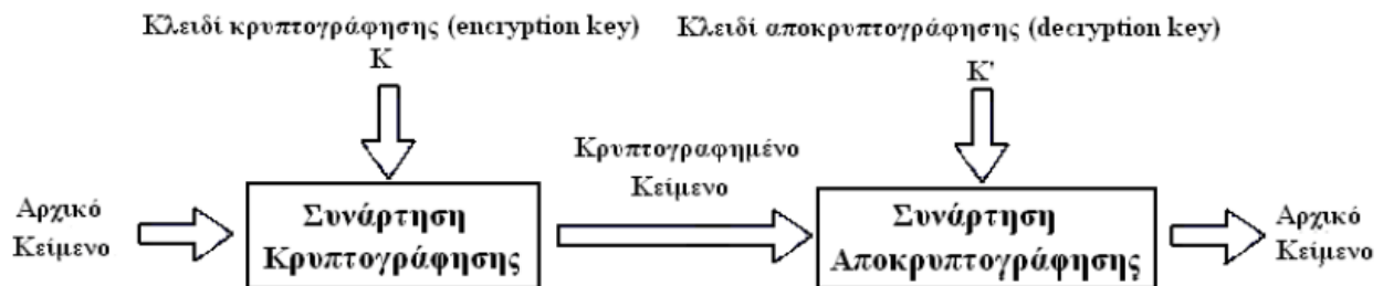
Σχήμα 1.3 Διαδικασία κρυπτογράφησης/αποκρυπτογράφησης με το διαφορετικό κλειδί
