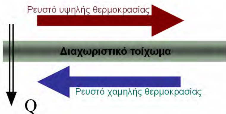
Εικόνα 2.12 Αρχή λειτουργίας εναλλακτών θερμότητας.
