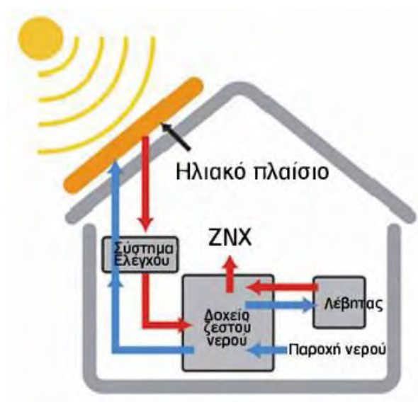
Εικόνα 2.5. Παραγωγή ΖΝΧ με ηλιακά πλαίσια
