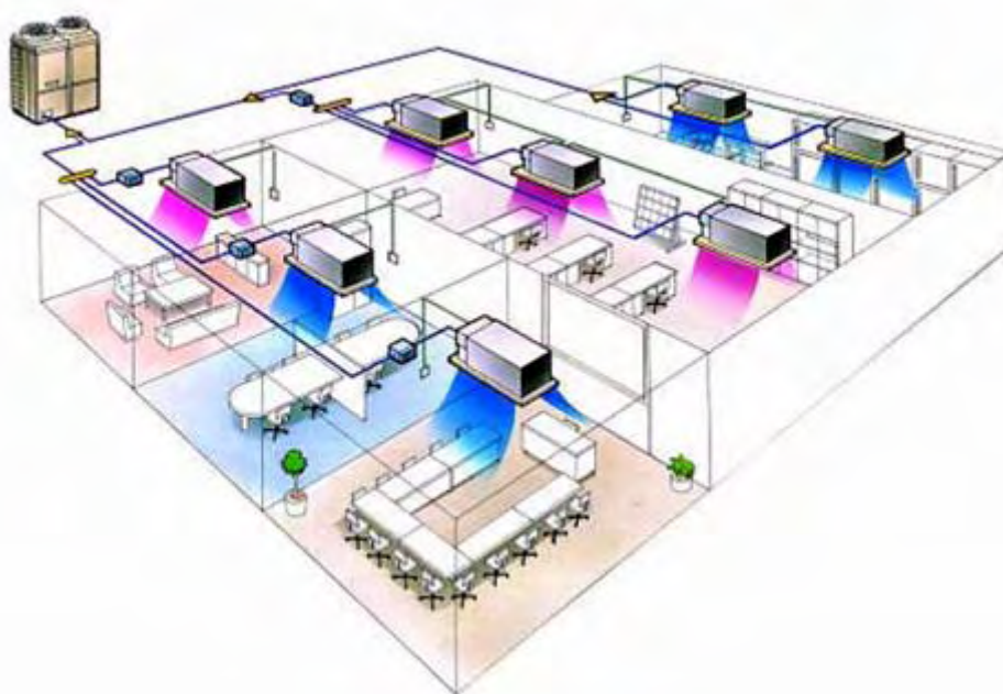
Εικόνα 3.4 Εγκατάσταση συστήματος VRV σε κτίριο.
