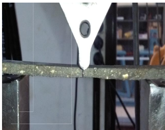
Εικόνα 2.3.1.1: Πειραματική διάταξη πειράματος κάμψης τριών σημείων(three point bending).
