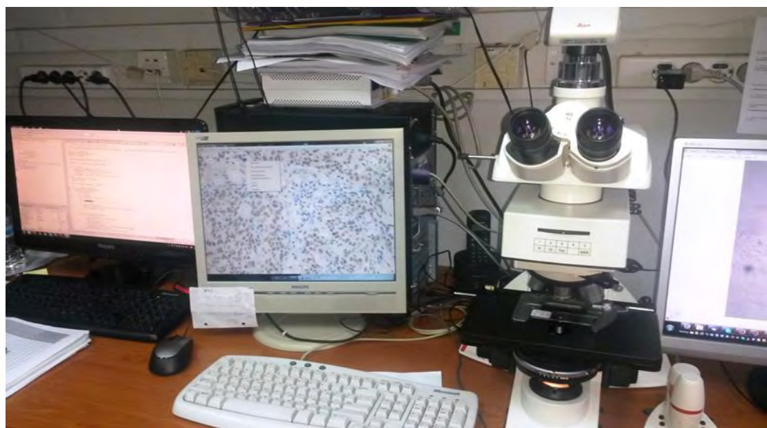
Σχήμα 2.9: Σύστημα μικροσκοπίου - ψηφιακής κάμερας - υπολογιστή.
