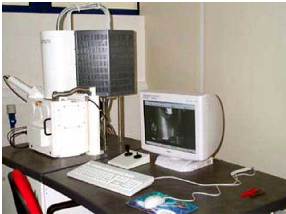
Σχήμα 7-6. Ηλεκτρονικό μικροσκόπιο σάρωσης μεταβλητής πίεσης με πηγή ηλεκτρονίων εκπομπής πεδίου με διακριτική ικανότητα 1nm στο υψηλό κενό και 2nm στο σύστημα μεταβλητής πίεσης (130Pa), στο ΕΙΧΗΜΥΘ
