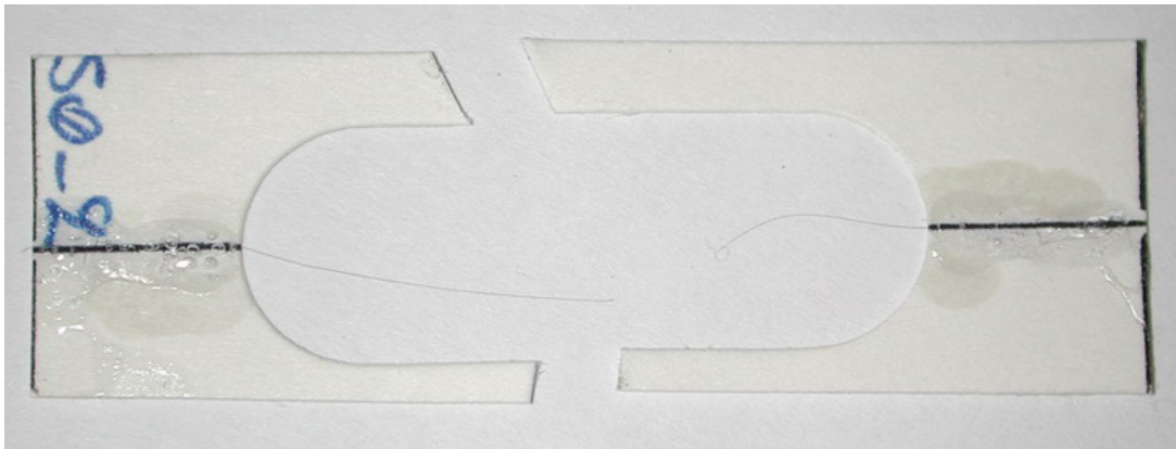
Σχήμα 7-2. Ένα τυπικό δοκίμιο ίνας άνθρακα ενεργού μήκους 25mm, μετά τη δοκιμή εφελκυσμού. Διακρίνεται η σπασμένη ίνα άνθρακα στο κέντρο.
