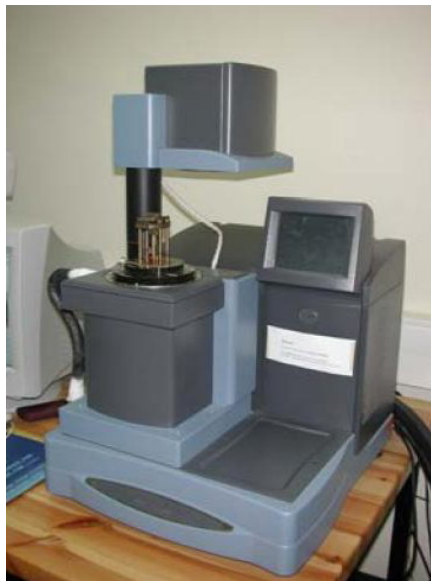
Σχήμα 7-4. Η συσκευή Δυναμικής Μηχανικής Ανάλυσης Q800 της TA Instruments, με ανοικτό το χώρο τοποθέτησης των δοκιμίων.
