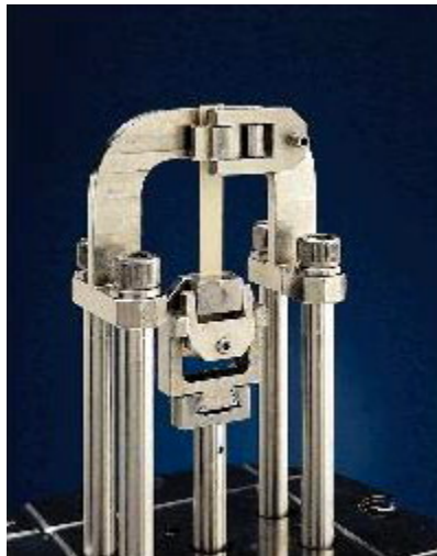
Σχήμα 7-5. Η αρπάγη για μετρήσεις σε υμένα.
