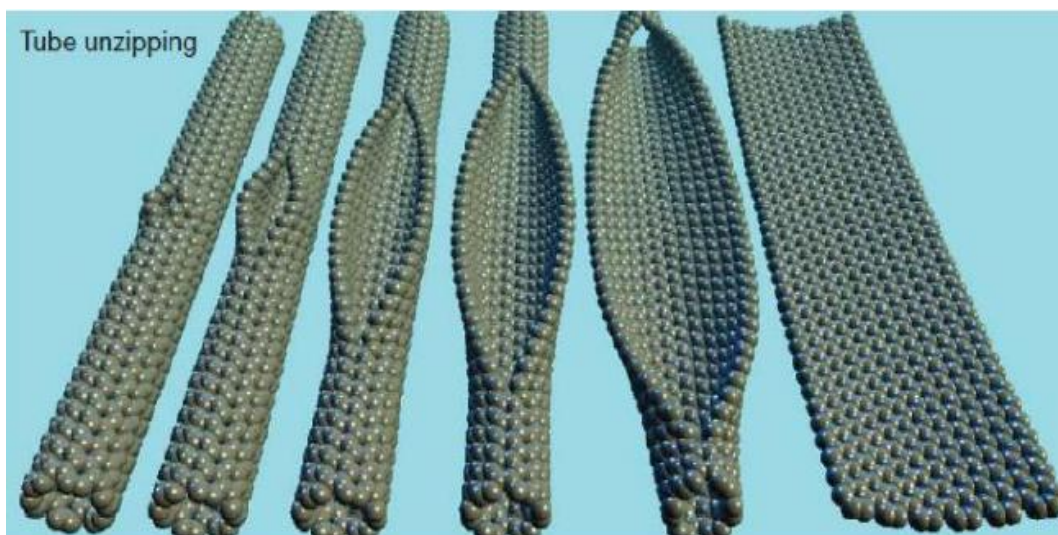
Σχήμα 1.12. Διαδικασία “ξετύλιγματος” των νανοσωλήνων άνθρακα για την παραγωγή γραφενίου [17].
