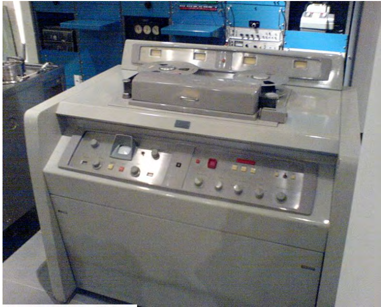
Σχήμα 2.8: Η πρώτη συσκευή εγγραφής βίντεο Ampex VR1000A
